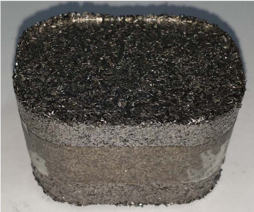
철 미세칩(Fe) 압축품 (60x40, 밀도: 5.4kg/리터) 자동차 부품 회사 (부산)
