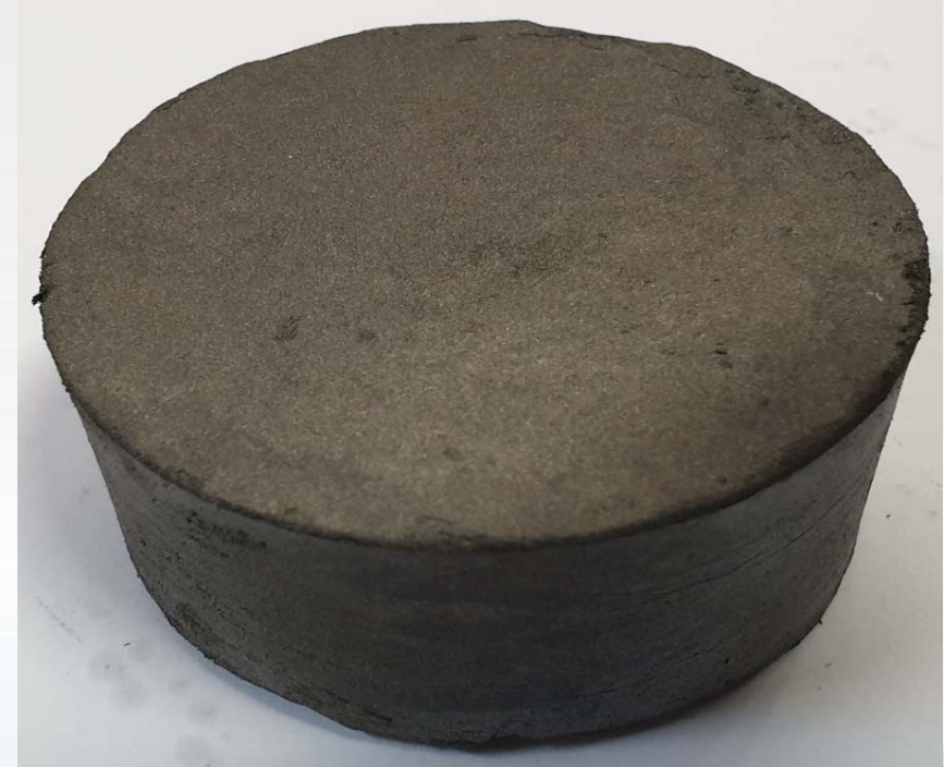
연마 슬러지(Fe) 압축품 (Ø60, 밀도: 2.32kg/리터) 자동차 부품 회사 (부산)
