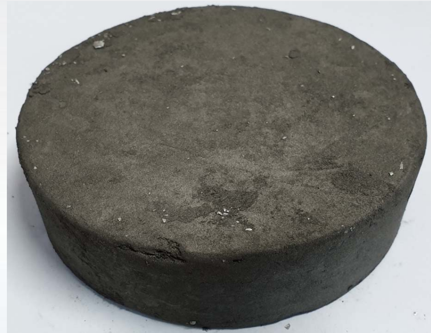
연마 슬러지(Fe) 압축품 (Ø100, 밀도: 2.89kg/리터) 자동차 부품 회사 (서산)
